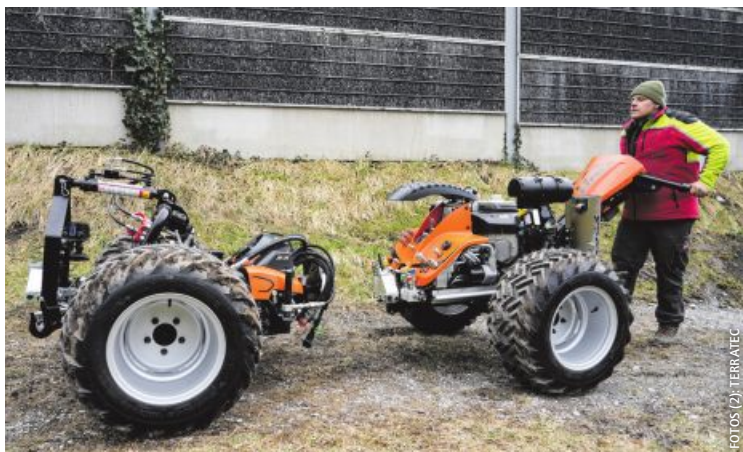
Die Ibex G3-V kann mit der Zusatzachse AX gekoppelt werden.
