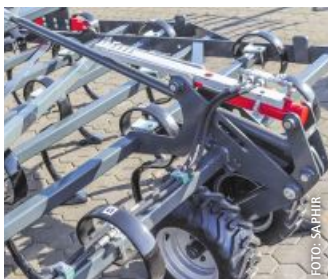
Saphir AllStar Longline mit hydraulischer Tiefenverstellung
