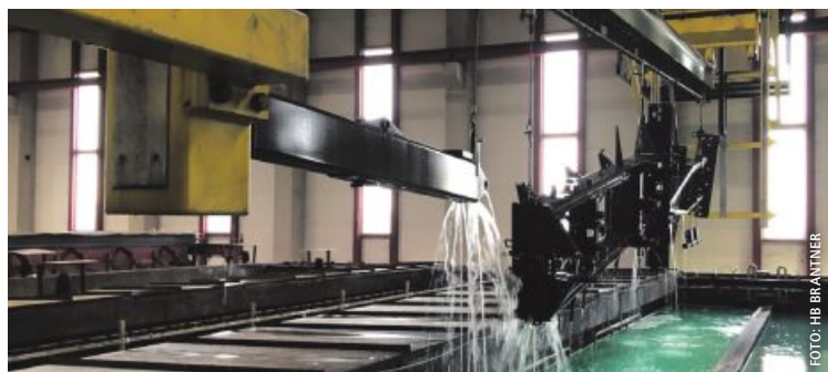
Die KTL-Beschichtung erfolgt durch Anlegen eines Spannungsfeldes
