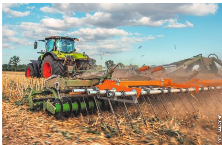
Der TopCut mit 12 Metern kann mit bis zu 20 km/h gefahren werden.
