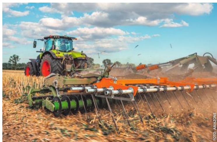
Der TopCut mit 12 Metern kann mit bis zu 20 km/h gefahren werden.
