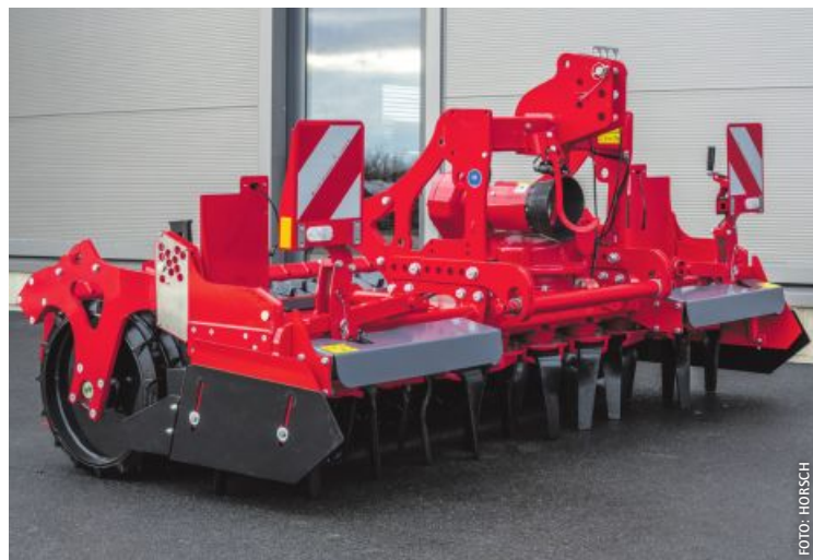
Die Kredo HD in der 3-Meter-Variante mit zehn Kreiseln
