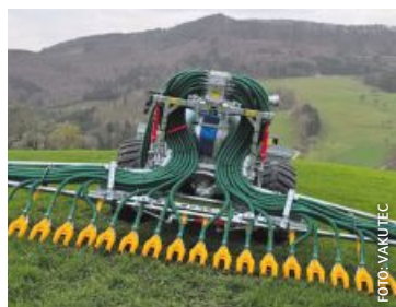
Der VarioFlex samt Schleppschuh und Duplo-Düse im Einsatz
