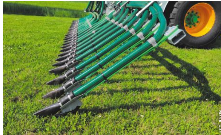
Bodennahe Ausbringung mit Schleppschuh reduziert auch den Geruch.
