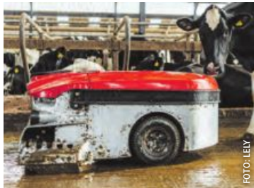
Der neue Lely-Roboter reinigt mittels Sandspülung große Kuhställe.
