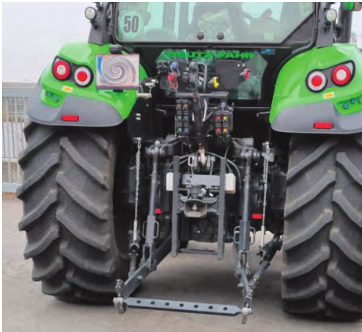
Das komplett ausgestattete Heck mit 100-mm-Hubzylindern
