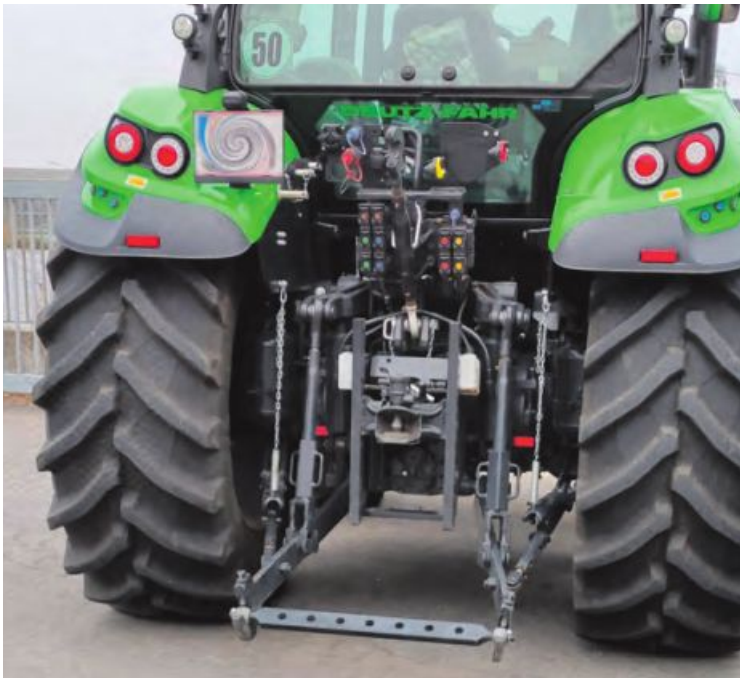
Das komplett ausgestattete Heck mit 100-mm-Hubzylindern
