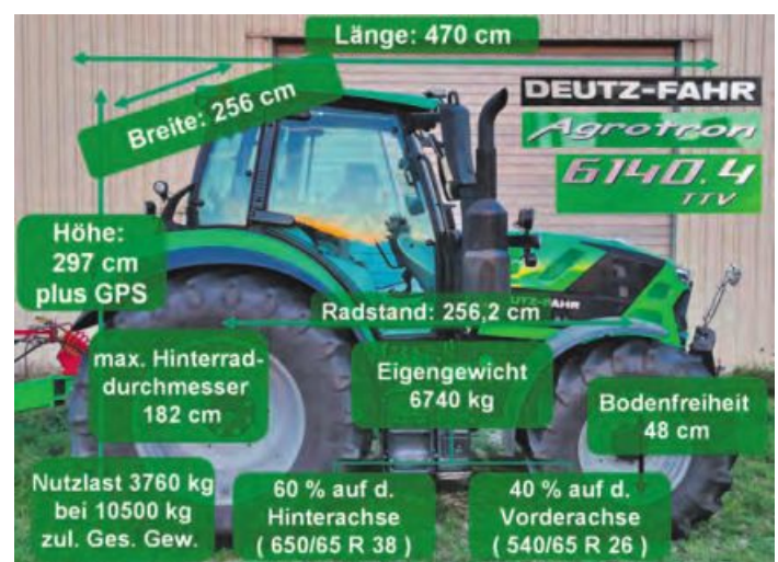
Abmessungen und Gewichte des Traktors von Deutz-Fahr
