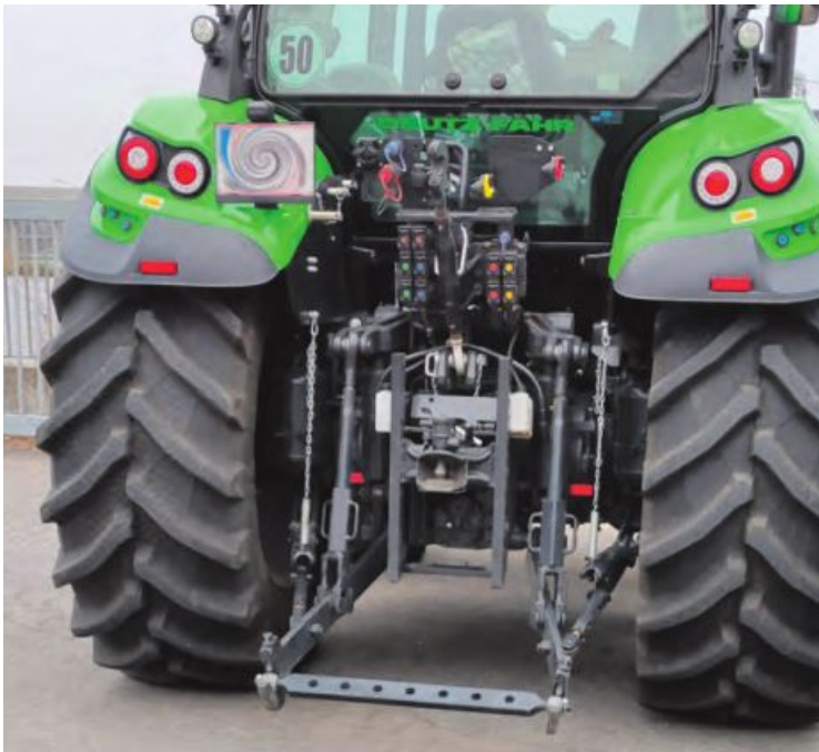
Das komplett ausgestattete Heck mit 100-mm-Hubzylindern
