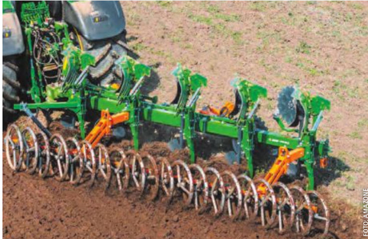
Der Teres 300 V mit integriertem Packersystem parallel geführt zum Pflug.
