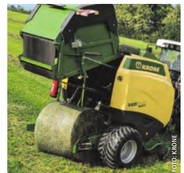
Die Klemme soll unkontrolliertes Wegrollen des Ballens verhindern.
