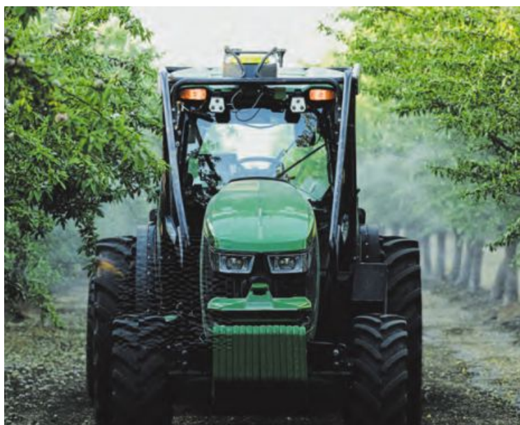
Der Obstbautraktor erkundet mit Lidar-Sensoren seine Umgebung.
