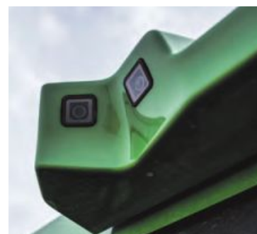
16 Kameras auf dem 9RX ermöglichen einen 360-Grad-Blick.
