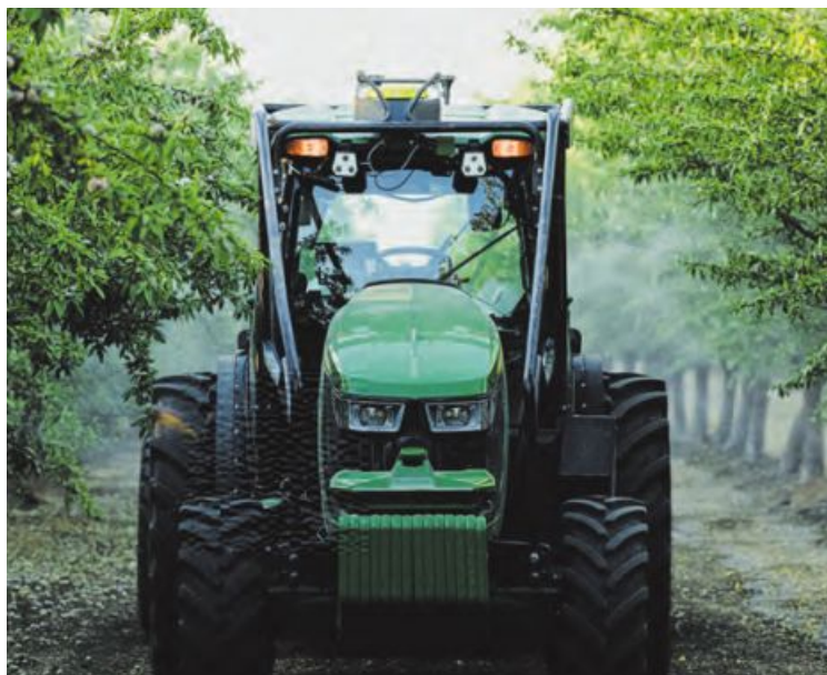
Der Obstbautraktor erkundet mit Lidar-Sensoren seine Umgebung.
