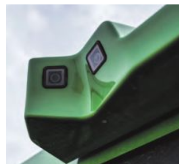
16 Kameras auf dem 9RX ermöglichen einen 360-Grad-Blick.
