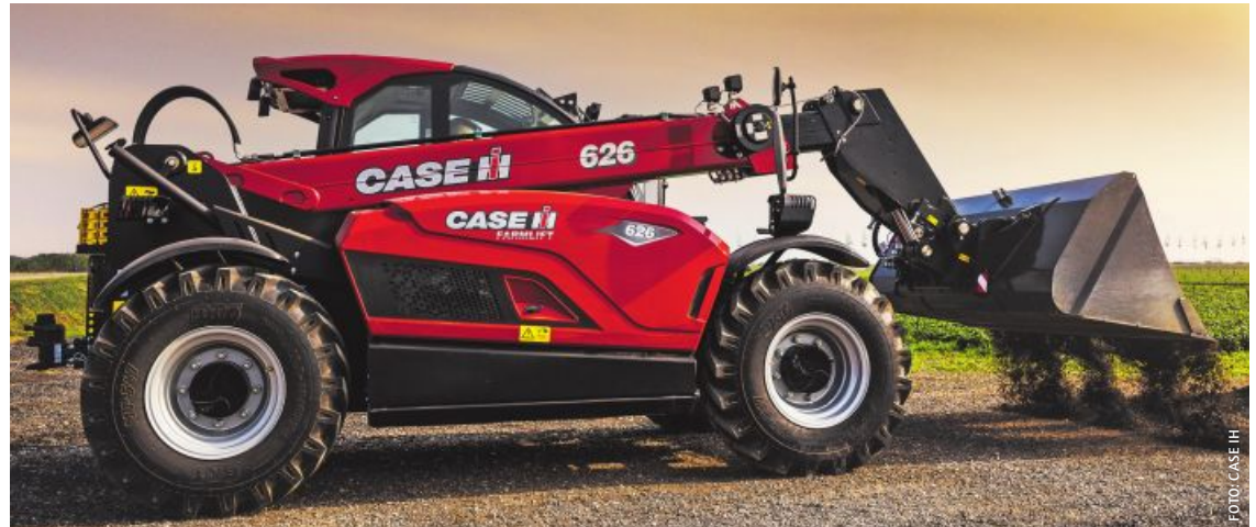
Mit mehr als vier Metern ist der Radstand des Farmlift 626 jetzt etwas länger, der Wenderadius mit 3,25 m aber kleiner.
