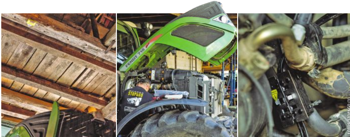
Ultraschallgeräte hoch oben am Balken der Scheune vertreiben die Marder. Die kleinen Boxen sind, wie auch das Clip-Hochspannungsgerät, unkompliziert zu installieren.
