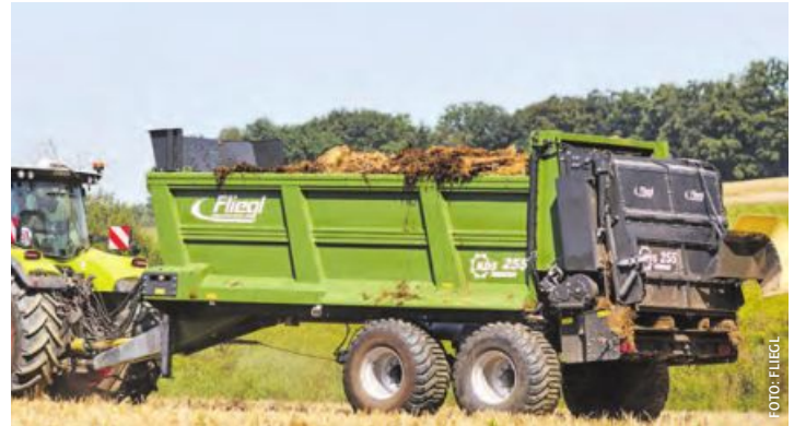
Den KDS 255 muck control gibt es mit bis zu 20 t zulässigem Gesamtgewicht.
