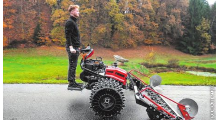
Mit heruntergeklapptem Trittbrett ist auch das Mitfahren möglich.
