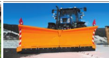
SOMA Schneepfuge, 1,5 - 3,3 m Arbeitsbreite, mit Hardox oder Gummischürfleiste, Großes Lager an Vario-u. Schwenkpfügen, mit mechanischer Anfahrtsicherung. 03170/225.
