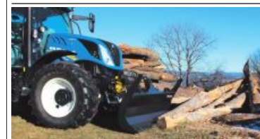
SOMA Polterschilder, unterschiedliche Baugrößen und Breiten verfügbar. Dreipunkt- oder Euroaufnahme, hydr. Greifer optional erhältlich, robuste Bauform. 03170/225.
