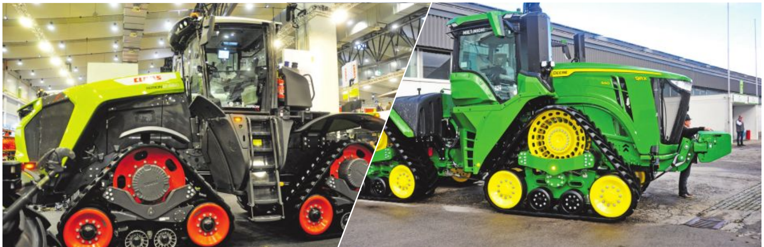
Starke Traktoren: Claas zeigte den Xerion 12.650 (auch „Tractor of the Year 2024“) mit bis zu 653 PS und John Deere den 9RX 640 mit bis zu 691 PS.
