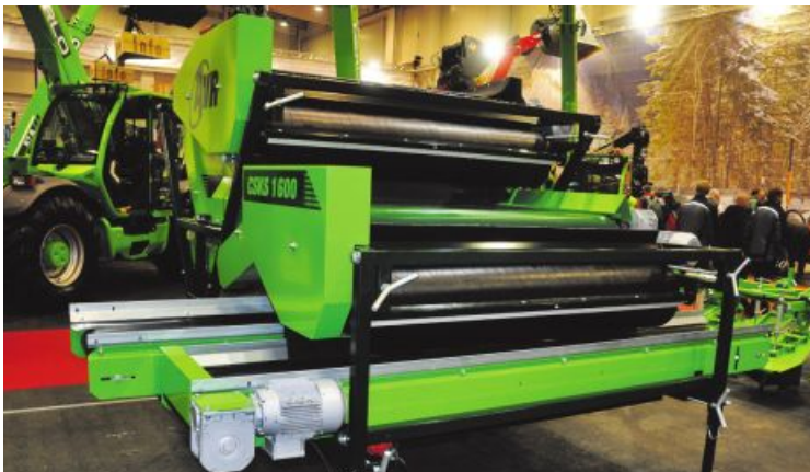
Statt klassischer Handverlese auf dem Kartoffelroder: Hammerschmied zeigte den Stein- und Klutentrenner CSKS von AVR. Das Modell 1600 soll mit zwei Trennrollen (Breite: 1,6 m) rund 18 Tonnen pro Stunde schaffen.
