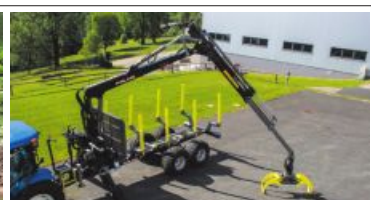
Palms Forstanhänger: 6-15 t Tragkraft, Hubstarke Kräne von 4,2 bis 10,1 m Reichweite. Neuheit: Forstanhänger für Quads. www.soma.at , 03170/225.
