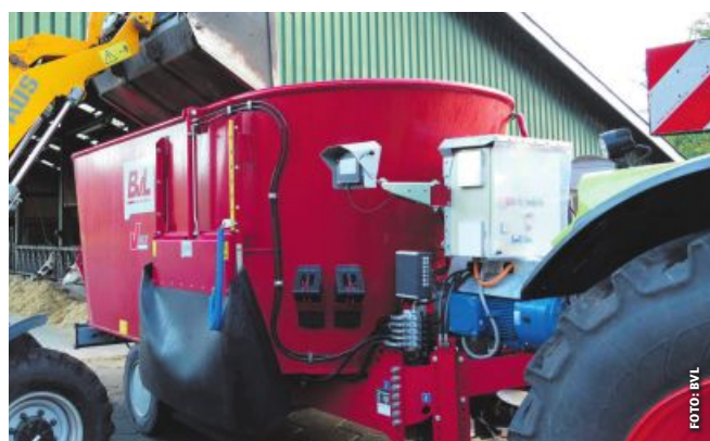
Ein konventioneller Futtermischwagen mit zusätzlichem E-Motor.
