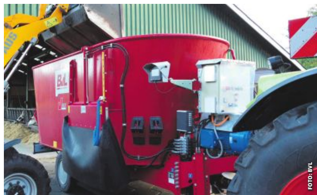
Ein konventioneller Futtermischwagen mit zusätzlichem E-Motor.
