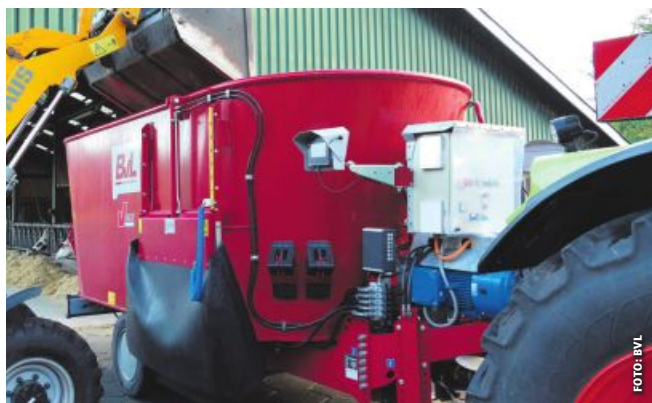
Ein konventioneller Futtermischwagen mit zusätzlichem E-Motor.
