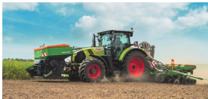
Einzelkorn-Sämaschine Precea 6000-2FCC mit dem FertiSpot-Dosierer
