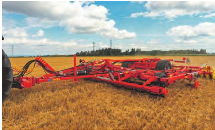
Der gezogene Flachgrubber PLANO VT 6060 ist 6-balkig aufgebaut.
