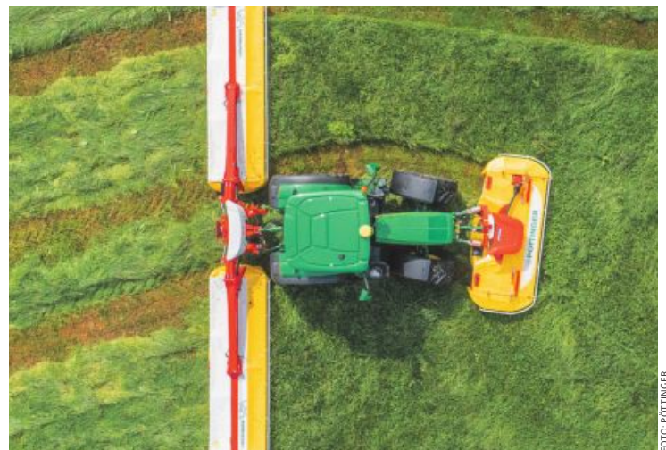
In Kurvenfahrten lenkt das Frontmähwerk mit.
