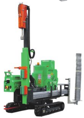
Die ZBM 24 mit Transportbox für Pfosten und Zaunabwickler
