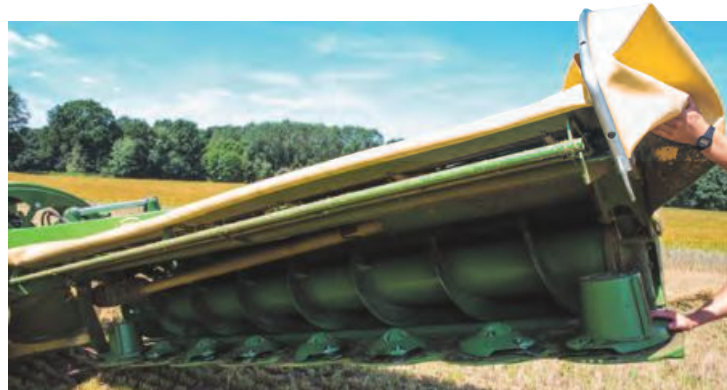
Leicht und nah am Schlepper ist das Schnecken-Schwadsystem angebaut.
