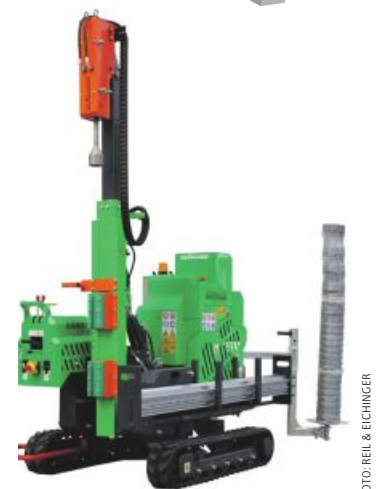
Die ZBM 24 mit Transportbox für Pfosten und Zaunabwickler
