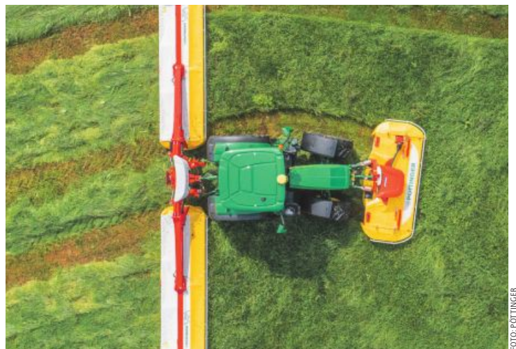
In Kurvenfahrten lenkt das Frontmähwerk mit.
