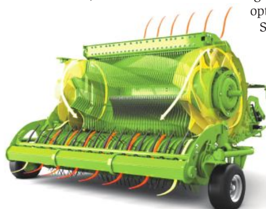
Der Integralrotor der OptiGrass-Ladewagen mit dem SplitCut-System
