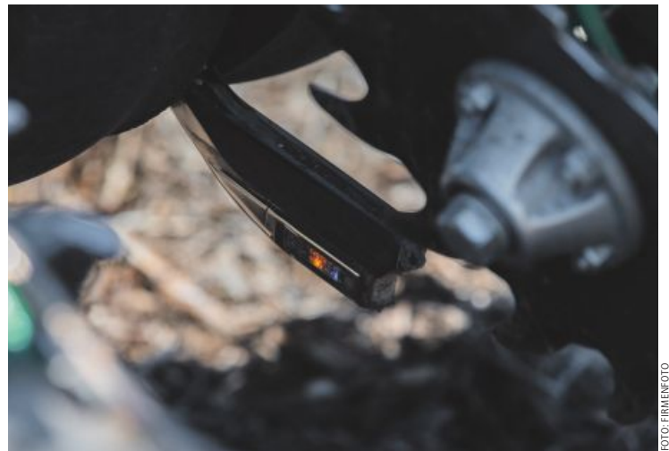
Im Zuge der Überfahrt misst der Sensor wichtige Bodenparameter.
