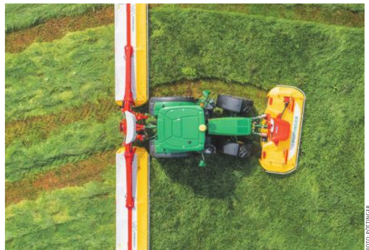
In Kurvenfahrten lenkt das Frontmähwerk mit.
