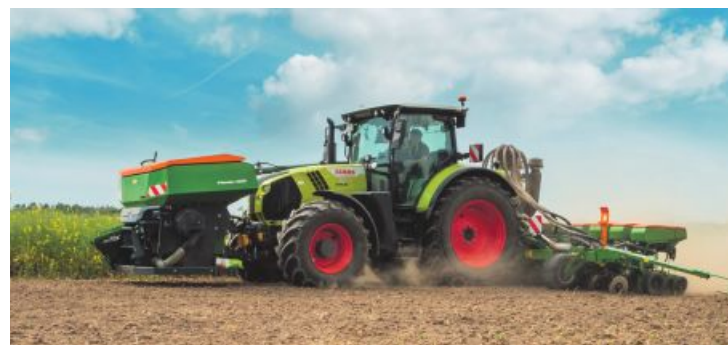
Einzelkorn-Sämaschine Precea 6000-2FCC mit dem FertiSpot-Dosierer
