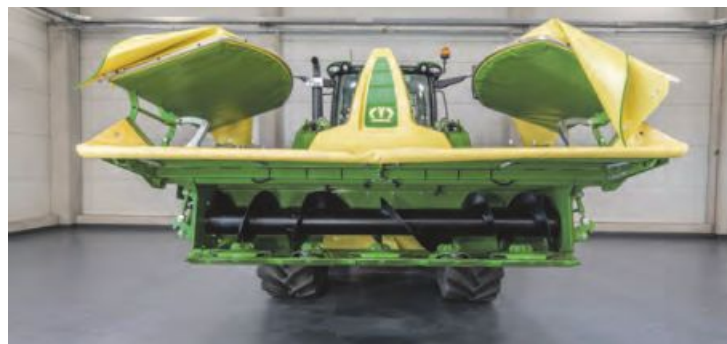
Krone EC F 400 Fold mit patentiertem Hydr. Klappholm 4 Meter Arbeitsbreite und 3 Meter auf der Straße
