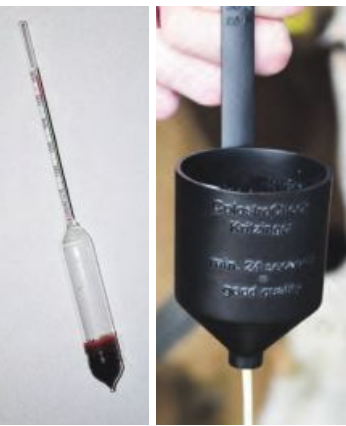
Refraktometer (l.), Senkspindel (m.) und ColostrumCheck eignen sich gleichermaßen zur Qualitätsbeurteilung der Biestmilch.
