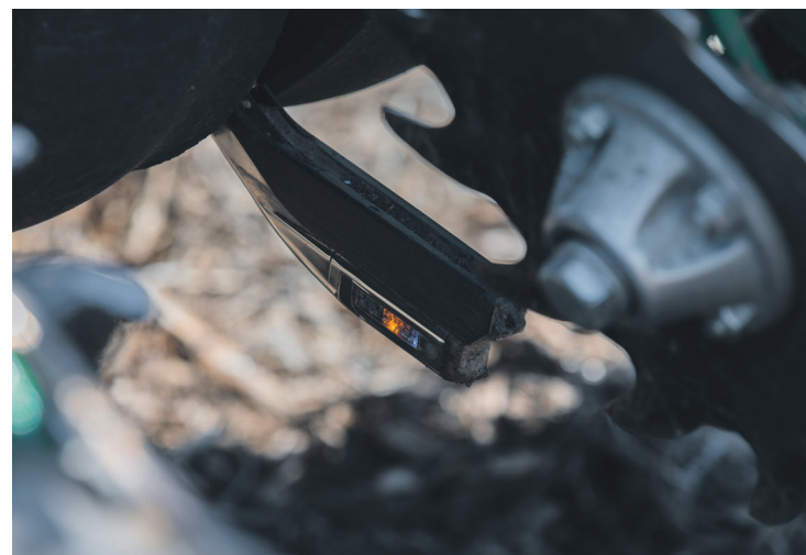
Im Zuge der Überfahrt misst der Sensor wichtige Bodenparameter.
