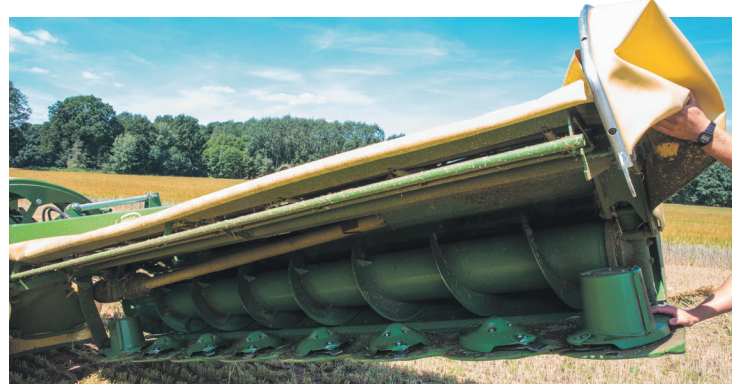
Leicht und nah am Schlepper ist das Schnecken-Schwadsystem angebaut.
