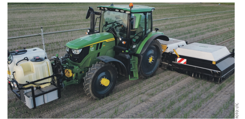
Die ARA-Feldspritze mit dem Doppeltanksystem an der Front.
