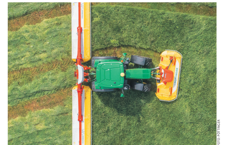
In Kurvenfahrten lenkt das Frontmähwerk mit.
