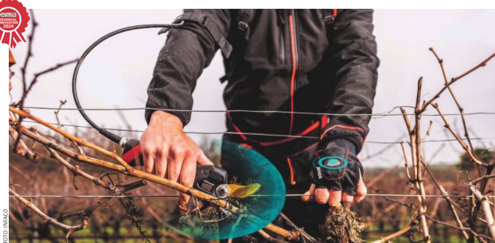
Eine kontaktlose Unterbrechungsschutzvorrichtung soll Schnittverletzungen verhindern.
