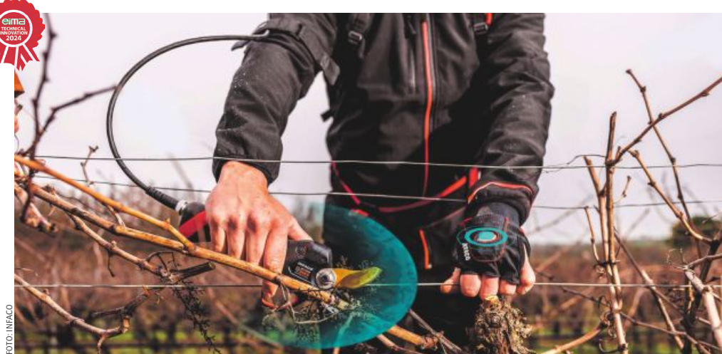
Eine kontaktlose Unterbrechungsschutzvorrichtung soll Schnittverletzungen verhindern.
