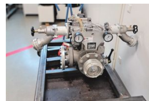
Eine alte Feuerwehrpumpe wurde zu einer mobilen Waschanlage umgebaut.
