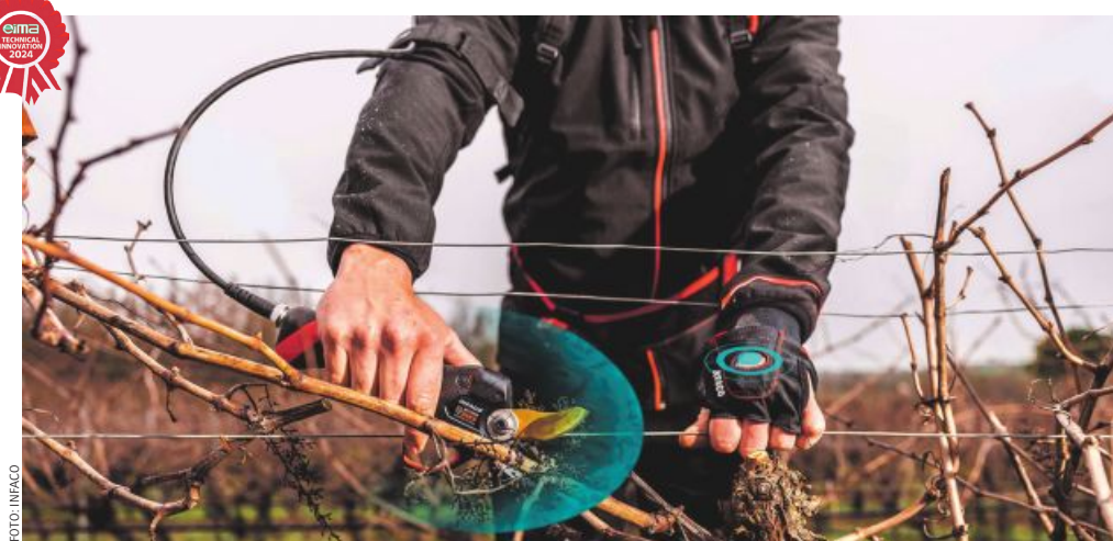
Eine kontaktlose Unterbrechungsschutzvorrichtung soll Schnittverletzungen verhindern.
