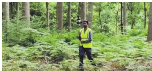
Waldinventur mittels personengetragenem Laserscanner.
