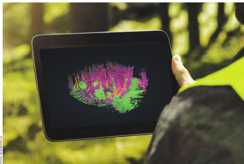
Nur knapp eine Stunde pro Hektar Wald – mittels RevoWood-Drohnen-Scan lassen sich bisher zeitraubende Bestandsaufnahmen sehr effizient erledigen.
