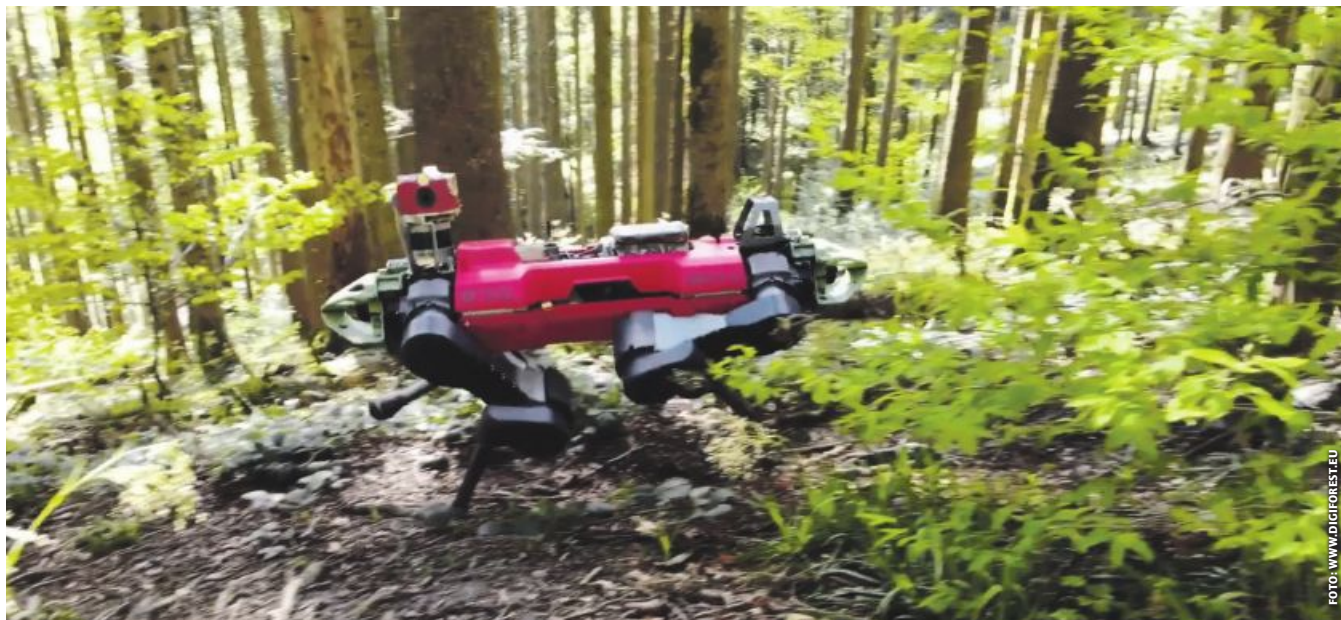
Waldinventur mittels Laserscanner – hier auf einem Schreitroboter montiert.
