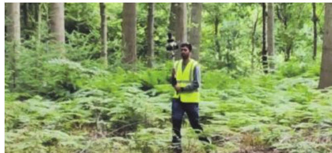
Waldinventur mittels personengetragenem Laserscanner.
