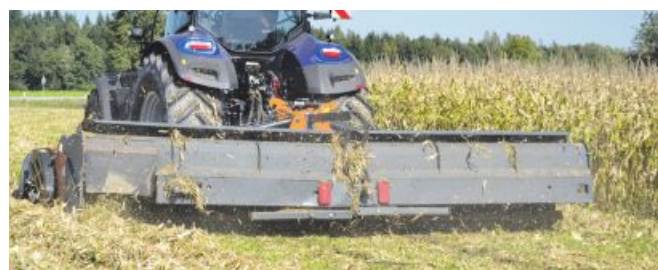
Der „BioChipper“ führt die Erntereste zu einem Schwad zusammen.
