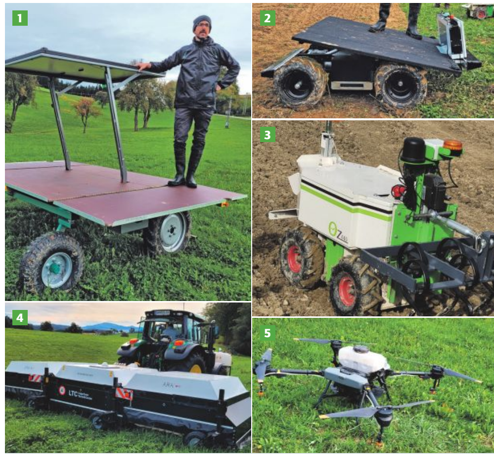
1 Autonomer Kistentransporter Valera von Ant Robotics mit GF Sandro Rabbiosi; 2 Roboter Adir Power von Ant Robotics; 3 Multifunktionaler Roboter Oz von Naïo Technologies; 4 Spotspraying-Spritze ARA von Ecorobotix; 5 Multicopter.
