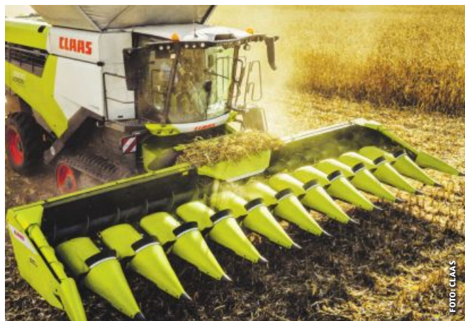
Der Vorsatz Rovio 4 auf einem Lexion-Mähdrescher
