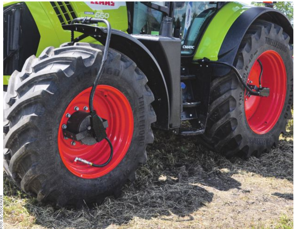
Immer mehr Hersteller bieten Reifendruckregelanlagen ab Werk oder zum Nachrüsten an.
