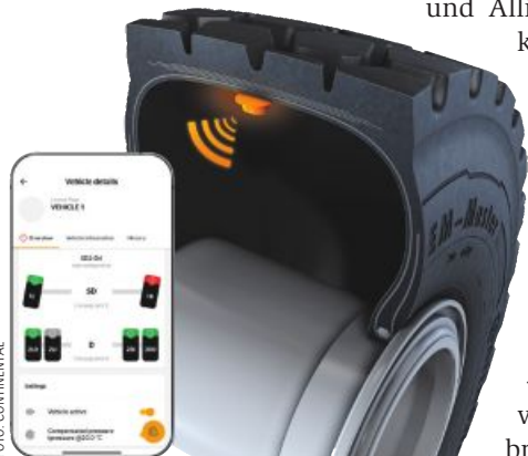
Über Sensoren und Bluetooth werden Reifenparameter am Smartphone angezeigt.
