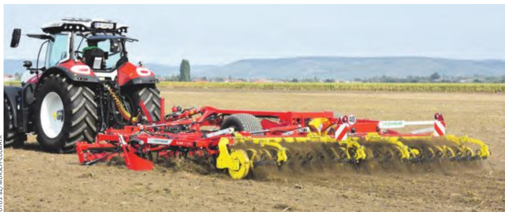
Im praktischen Einsatz: Anbaudrehpflug Servo 2000, Kurzkombi Fox 3000 D und Flachgrubber Plano VT
