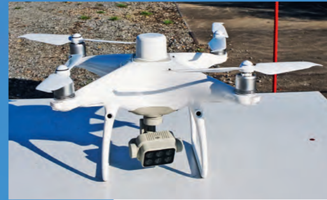
◀ DJI-P4-Standarddrohne: bietet hochgenaues GPS und Multispektralkameratechnik.
