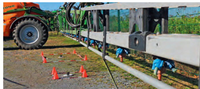
Bei Spritzen mit Einzeldüsensteuerung ist das Zielfeld deutlich kleiner (im Vordergrund abgesteckt) als bei Sektorsteuerung, der Mittelaufwand sinkt deutlich.
