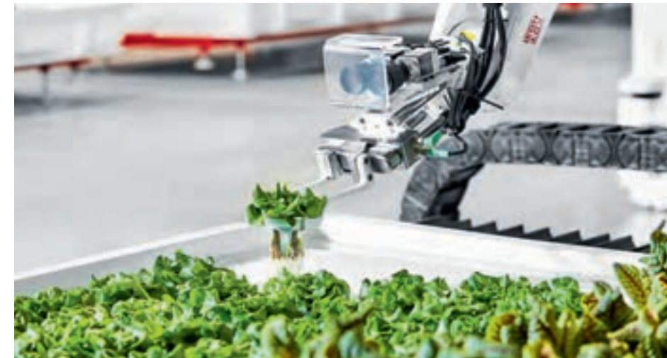
Der Roboterarm greift die Pflanzen und erkennt Krankheiten und Schädlingsbefall.
