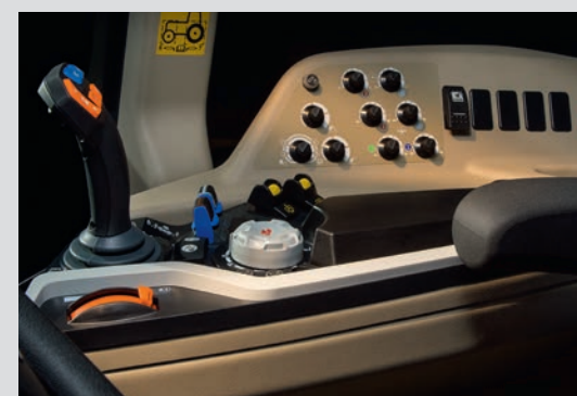
Umfassende Getriebe- und Hydrauliksteuerung mittels MF-Multifunktionsjoystick.
